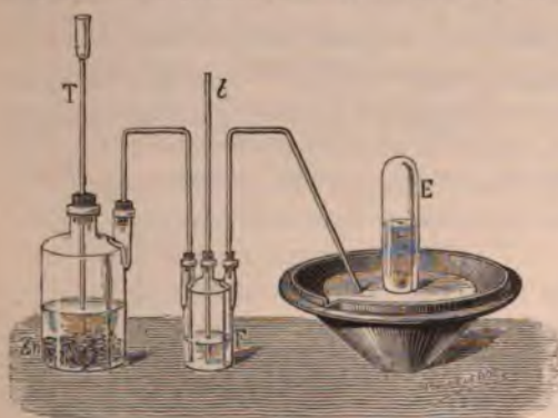
Fig. 15. — Préparation de l'hydrogène. Zn, Zinc et eau acidulée. — F, laveur. — E, gaz dégagé.
